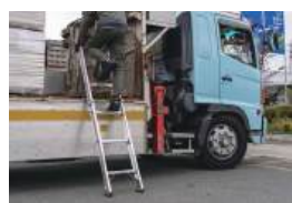
ラクノリ 最上段ステップを外すことで、 面から乗り移りを可能にしました。
