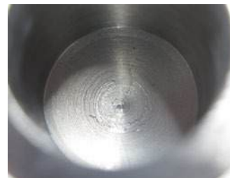
切削速度が低く送り量が高い場合
