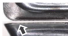
従来品 (切削長さ32m) 微小チッピング
